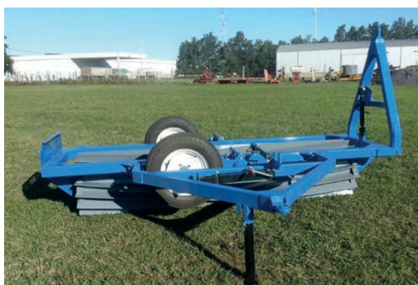
Rolo mellador de cuchillas helicoidales en posición de trabajo. Carcaraña, Santa Fe, 2019.
