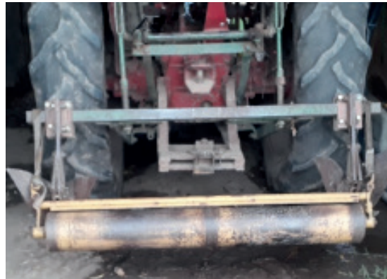
Escardillo de 3 puntos adaptado para elaboración de platabanda con rolo asentador de lomo. Villa Gdor Galvez, Santa Fe.
